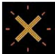
闪烁的橙色叉号 是一般警示信号，表示该车道前方或有障碍。车道虽可通行，但司机必须放慢车速并准备改换车道
