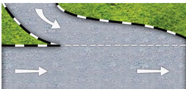
(h) 加速车道的间断单白线
