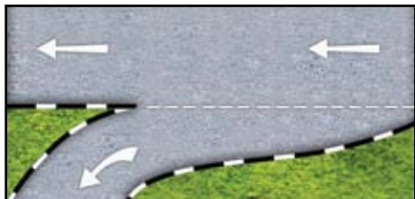
(i) 减速车道的间断单白线
